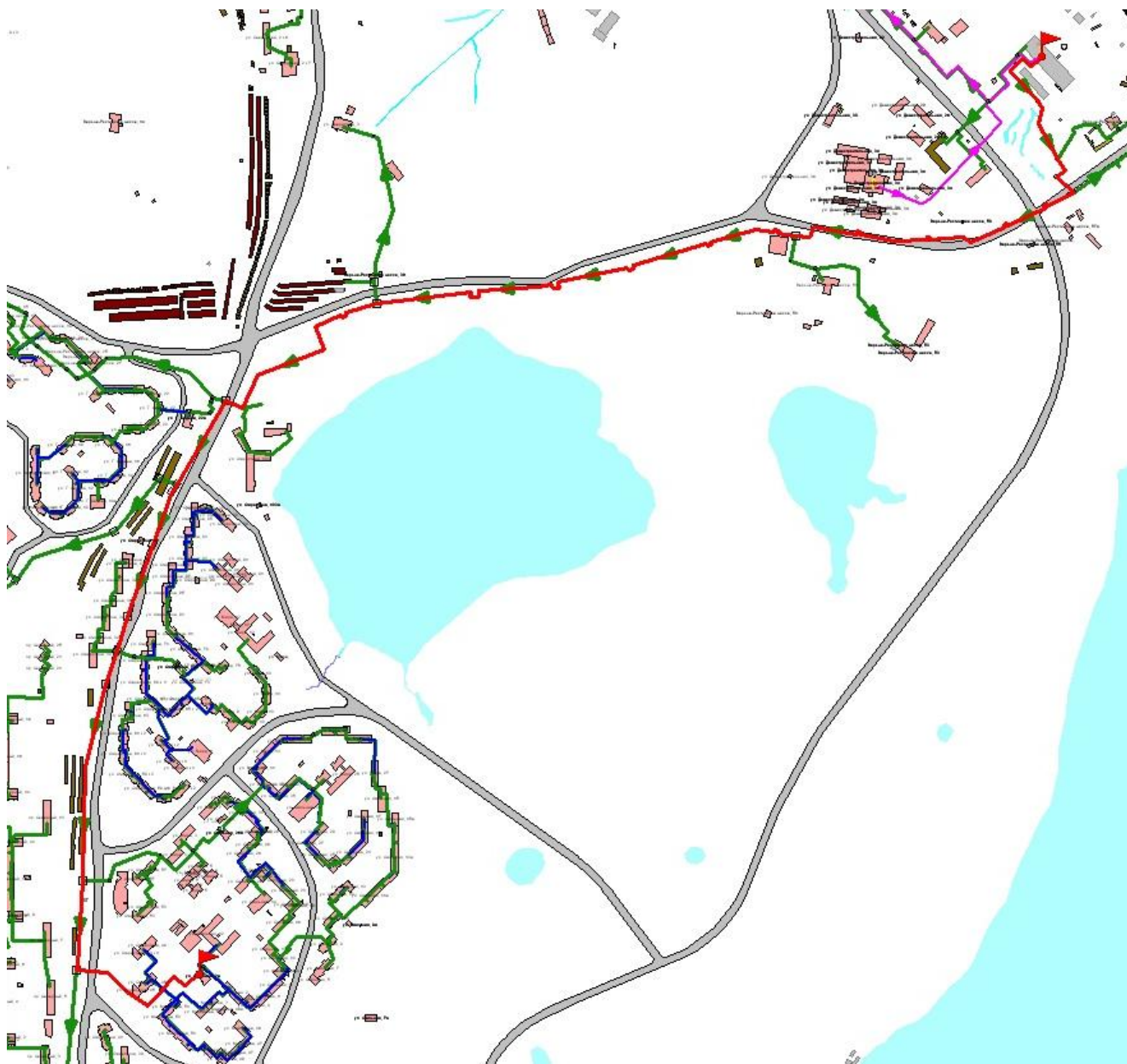
Рисунок 1.37. Путь построения пьезометрического графика Восточная котельная –ЦТП №1
