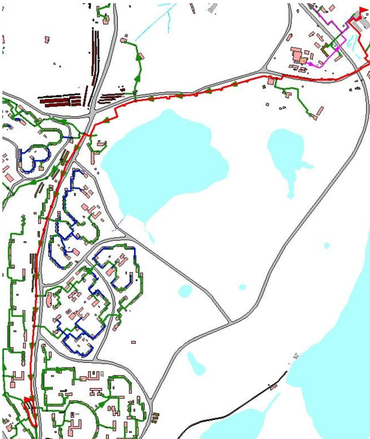
Рисунок 1.34. Путь построения пьезометрического графика Восточная котельная – НС №7
