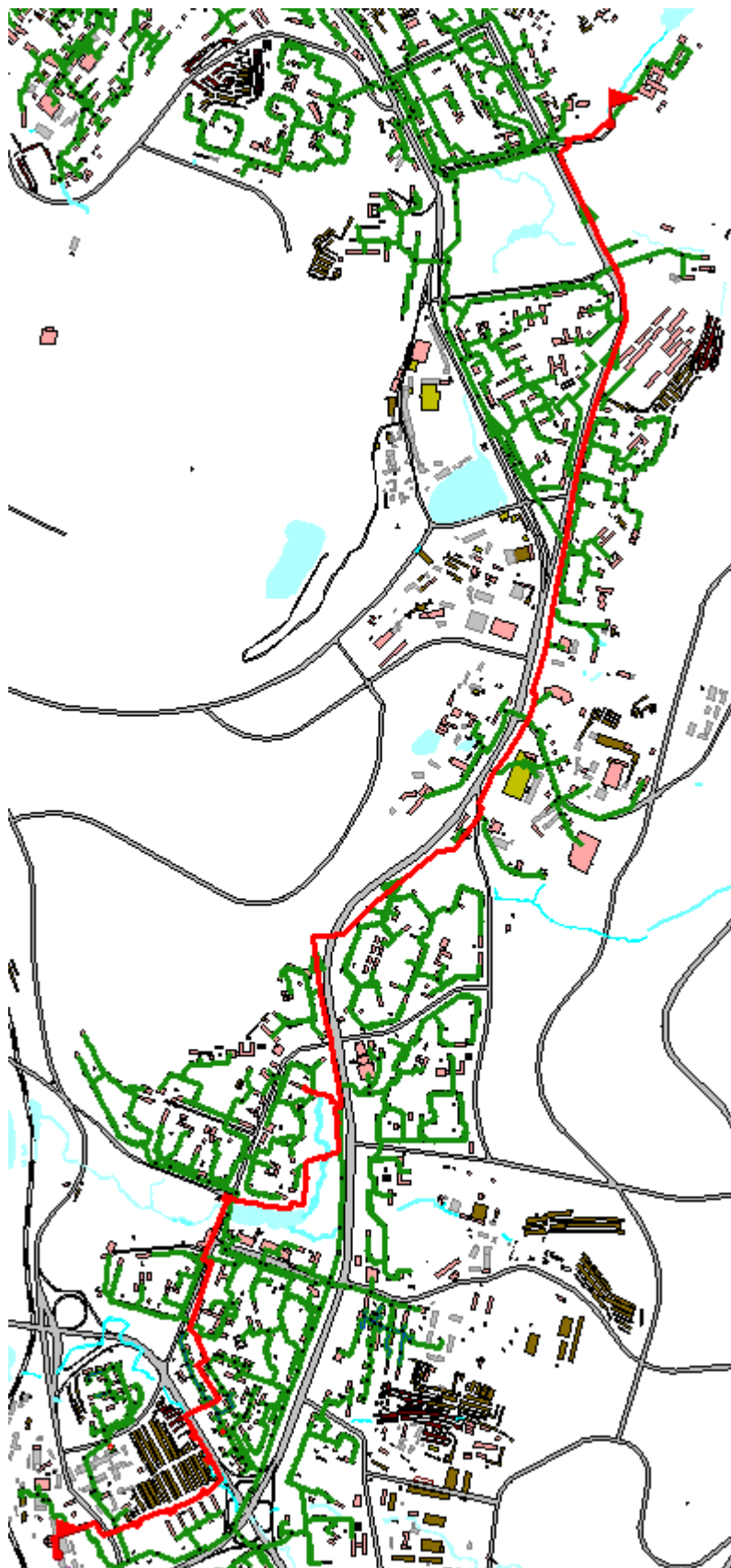
Рисунок 1.23. Путь построения пьезометрического графика Южная котельная – НС №9
